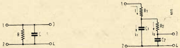
Fig. 50. - Filtro passa basso a RC in parallelo alimentato a corrente costante.
