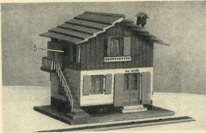
Due aspetti della originale e graziosa realizzazione. 1 = comando sintonia; 2 = commutatore gamma; 3 = manopola a guida per detti; 4 = portacenere; 5 = interruttore e volume.
